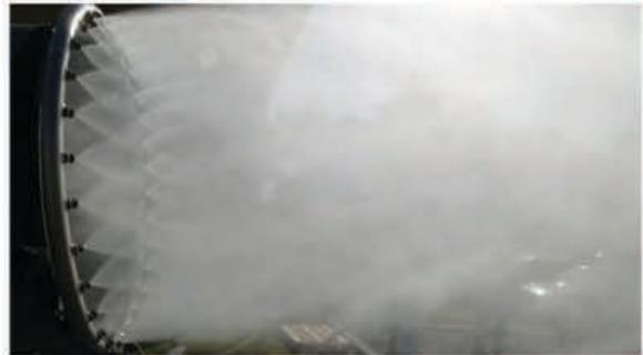
Las gotas generadas por el **UMAP 30** poseen un diámetro volumétrico medio de 100 micrones con las cuales se logra una efectividad de captura de polvos 10 veces mayor que los sistemas de riego por aspersión utilizados. Dicho de otro modo: con el **UMAP 30** utilizará 10 veces menos cantidad de agua que con un cañón de riego convencional y logrará alta eficiencia de captura de polvos, especialmente los PM10.
